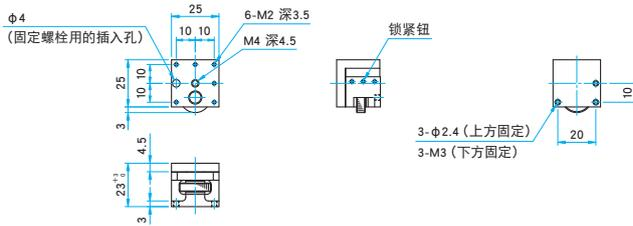
**TASB-403/403UU** 内六角螺栓 M3×8...3个, 六角扳手...1个 内六角螺栓(不锈钢) 6-32UNC×5/16...3个, 六角扳手...1个(UU) 锁紧钮用扳手尺寸1.5mm 1.5mm六角扳手(UU)
