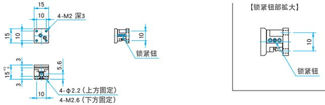
**TASB-253** 内六角螺栓 M2×6...3个, 六角扳手...1个 锁紧钮用扳手尺寸0.89mm
